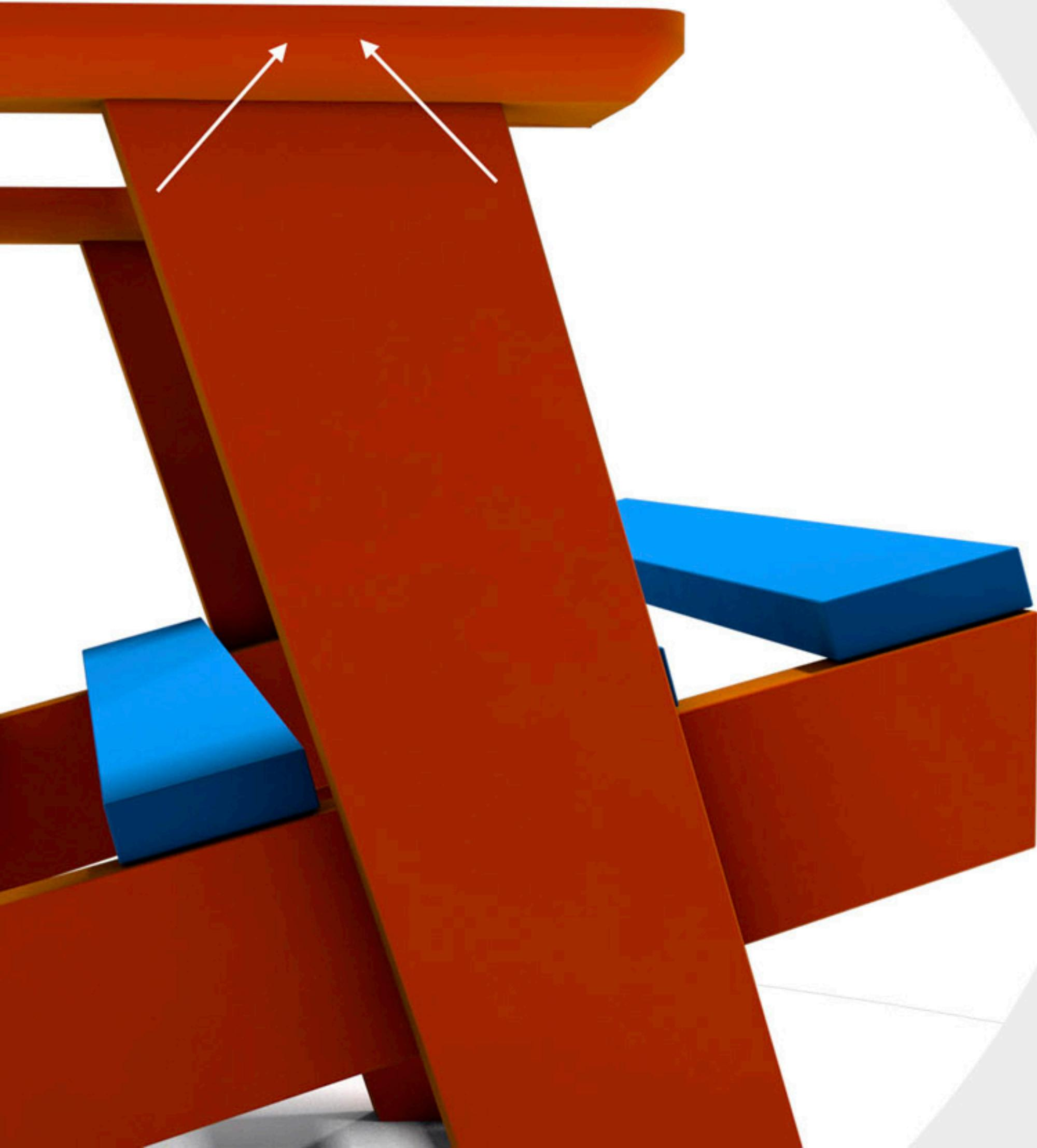
Так саморезы крепят ручку к передней ножке. Сперва нужно насверлить в ножке отверстие чуть шире шляпки самореза и глубиной 5-8 мм.
